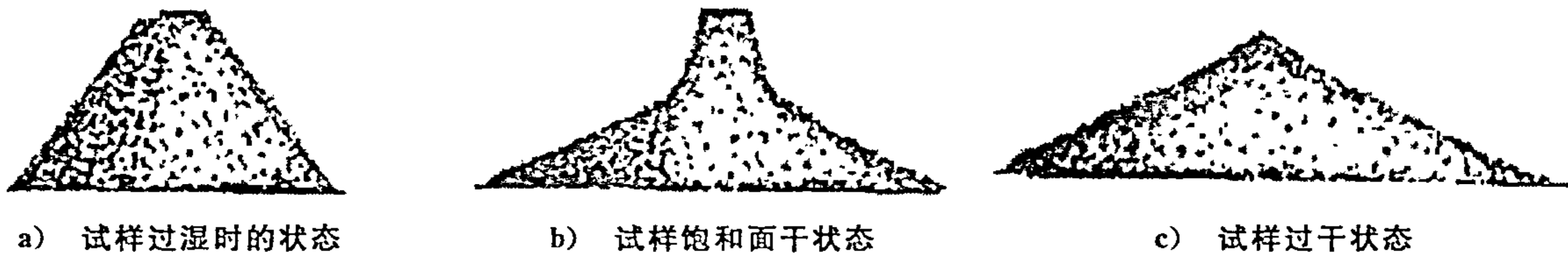
图3 机制砂饱和面干试样的状态
